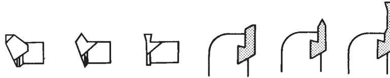
**Tête:** La partie tranchante d'un outil de tournage intérieur se composant de plusieurs pièces.
