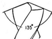
Fig. 51. Pointe plate pour matières dures et fortes (Rails en acier au manganèse, etc.)
