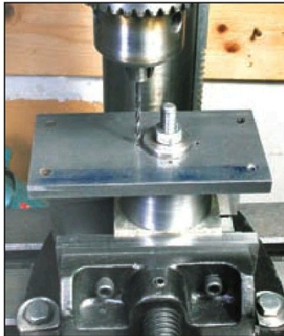
13. Utilisation du moyeu de transmission N (23), comme support de perçage, il est contre-percé à travers la platine de transmission
