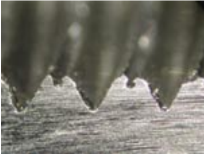
Section de filet obtenu par enlèvement de matière sur de l'acier C45
